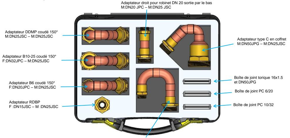
Adaptateur coudé à 180° pour robinet DN20 sortie vers le haut M:DN20 JPC – M:DN25 JSC
